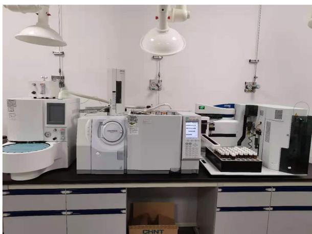
图 1 气相色谱质谱联用仪GCMS-QP2010SE
