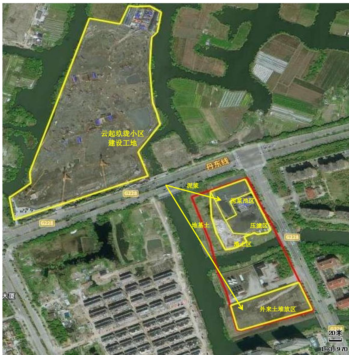
图 2-19 地块内泥浆固化池、外来土堆放区平面图
