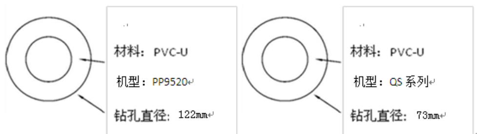
图 5-4 井管结构示意图
