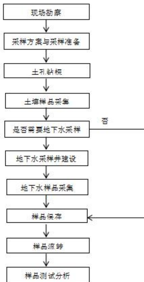
图 5-13 样品采集、保存、流转工作程序图
